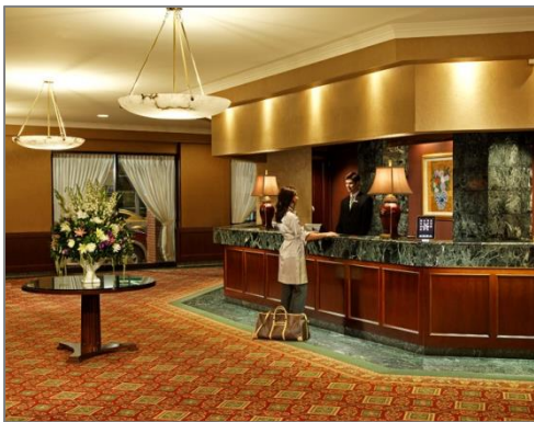
Figuur 22: Voor hospitality (vb. in hotels) kiest men meestal voor warme kleurtemperaturen (2700 à 3000K).
