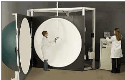
Figuur 14: Een integrerende sfeer of bol van Ulbrich. De lamp wordt in de bol geplaatst. Een detector, die afgeschermd wordt van de lamp zelf, ziet dankzij de witte coating van de bol een gemiddelde van het licht van de lamp. Uit dit gemiddelde kan eenvoudig de lichtstroom berekend worden.
