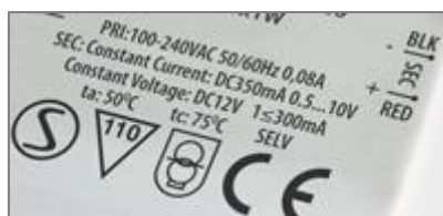
Figuur 51: Universele LED driver: bepaalt automatisch of constante spanning (12V) of constante stroom (350mA) nodig is voor de aangesloten leds.
