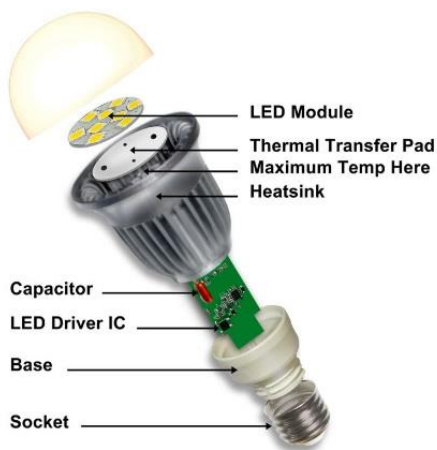
Figuur 62: Geopende ledlamp. In de lampvoet zit de dimbare leddriver.
