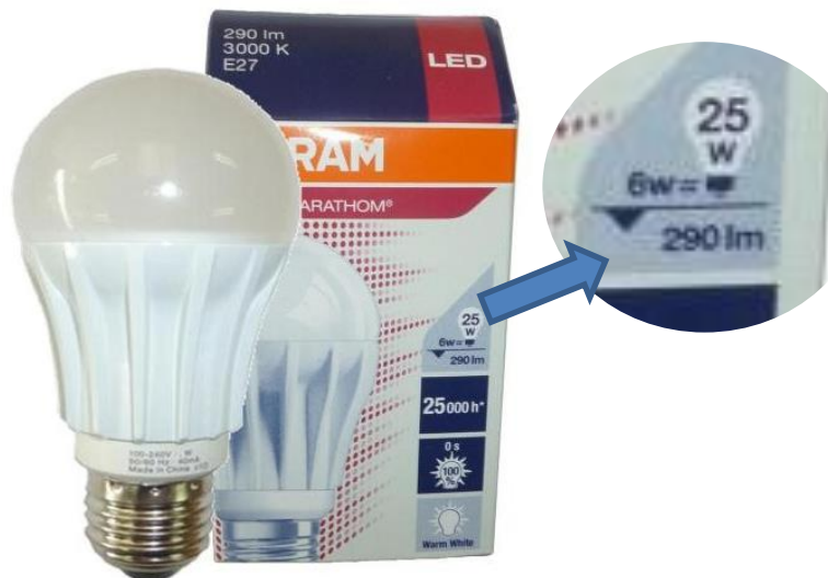
Figuur 8: Deze lamp levert 290lm. De fabrikant geeft aan dat dit ongeveer overeenkomt met een 25W gloeilamp. Het elektrisch vermogen van de ledlamp (6W) is geen goed middel om ledlampen te vergelijken.
