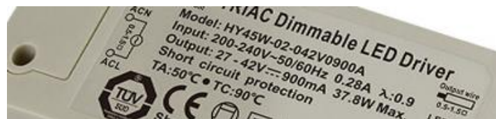
Figuur 49: Constante stroomvoeding: levert 900mA. De som van de voorwaartse spanningen van de (in serie geschakelde) leds moet tussen de 27 en de 42V liggen. De voeding zal niet correct werken als er te weinig leds worden aangesloten!
