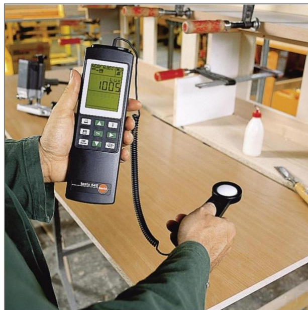
Figuur 16: Meting met de luxmeter in een lokaal.
